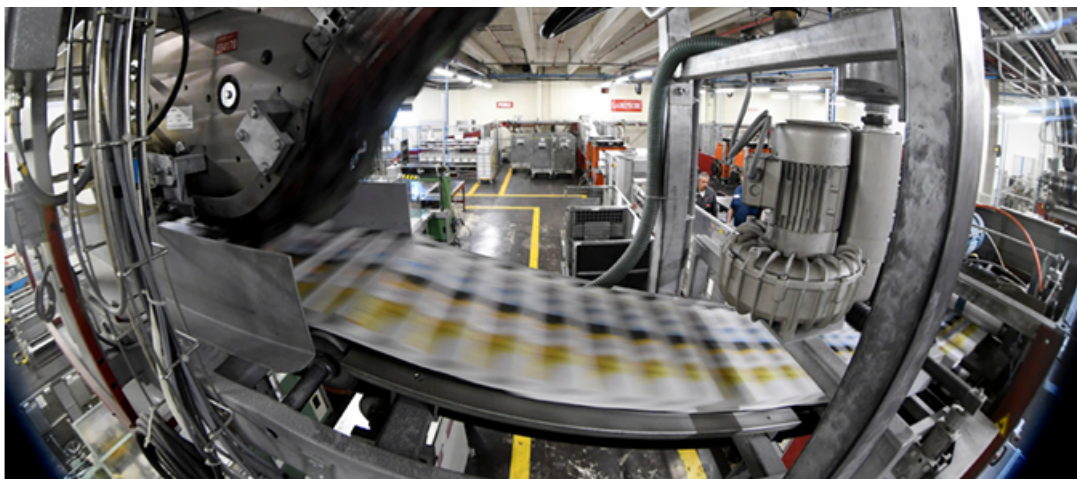
▲ La capacité d'impression des deux rotatives Heidelberg Mainstream de L'Occitane d'Imprimerie, à Toulouse, pourrait atteindre, en cas de pic de production, 160 000 exemplaires par heure.
