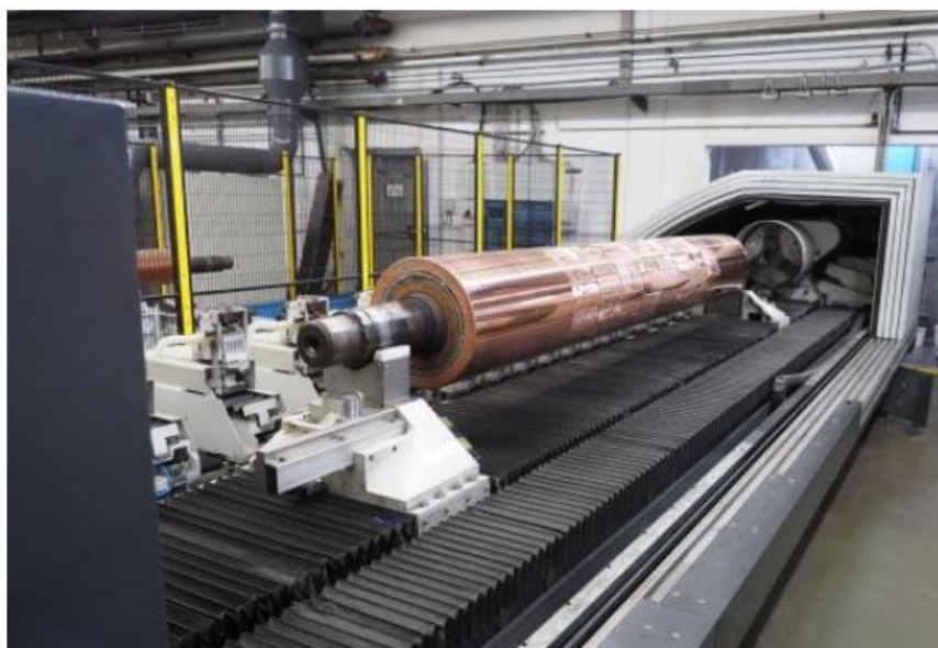
Le chromage des cylindres d'impression gravés est un processus de production nécessaire pour lequel de nouvelles voies sont actuellement recherchées.
